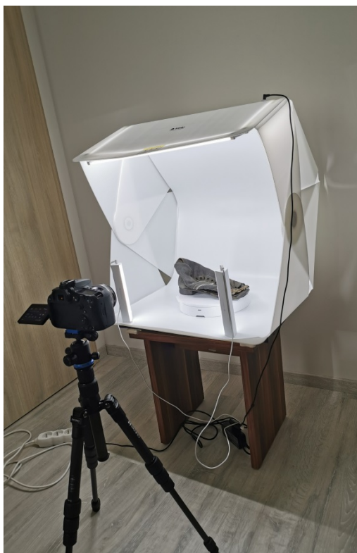
Obr. 2 Nastavení pro poloautomatické sériové fotografické snímkování.
